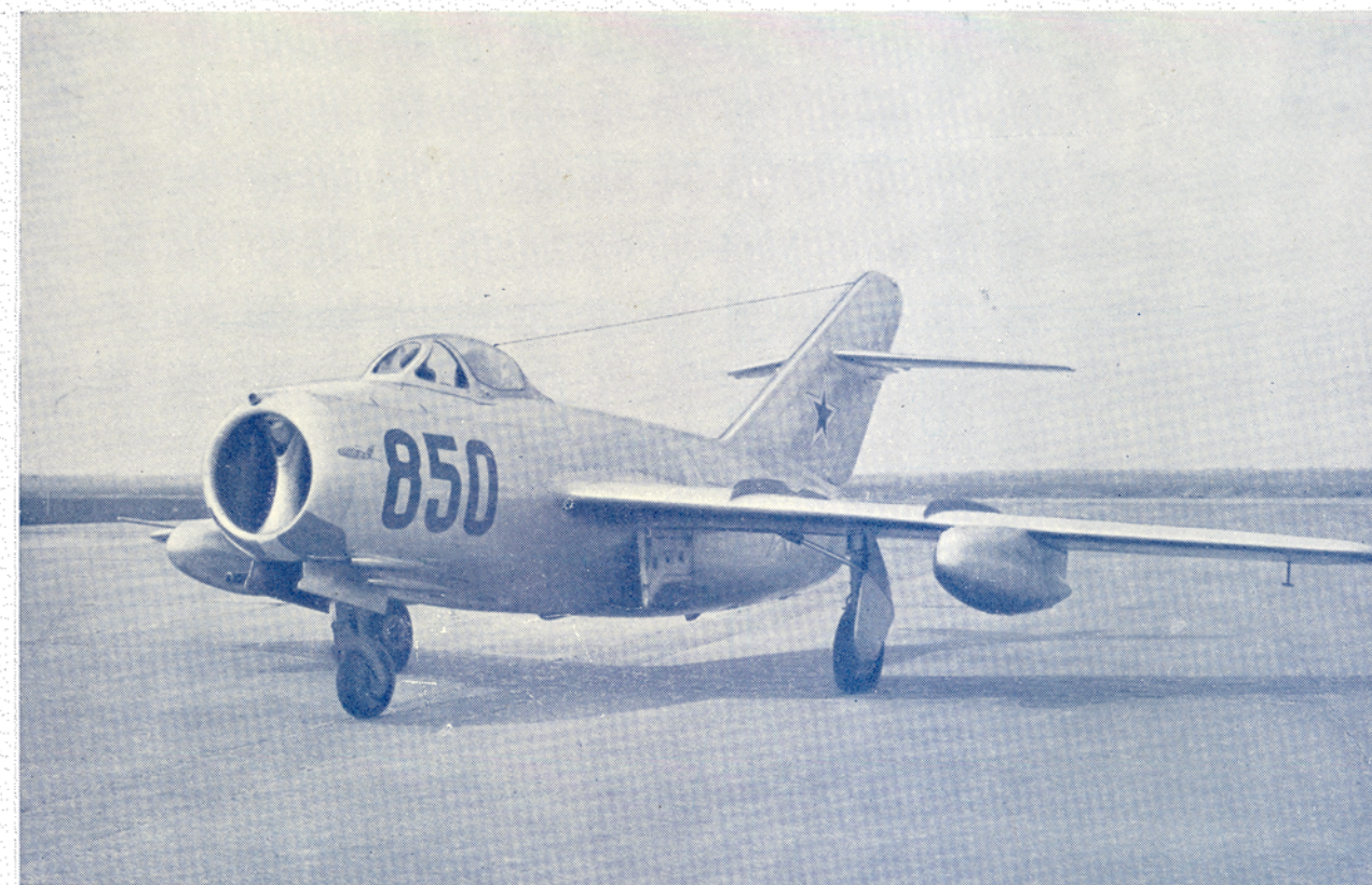
Фиг. 5. Общий вид самолета МиГ-15бис с малыми подвесными баками 2×300 л.
